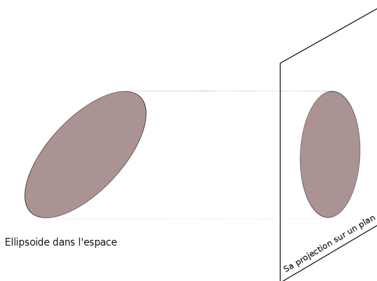
FIGURE 2.7 – La projection d'un ellipsoïde sur un plan forme une ellipse.
