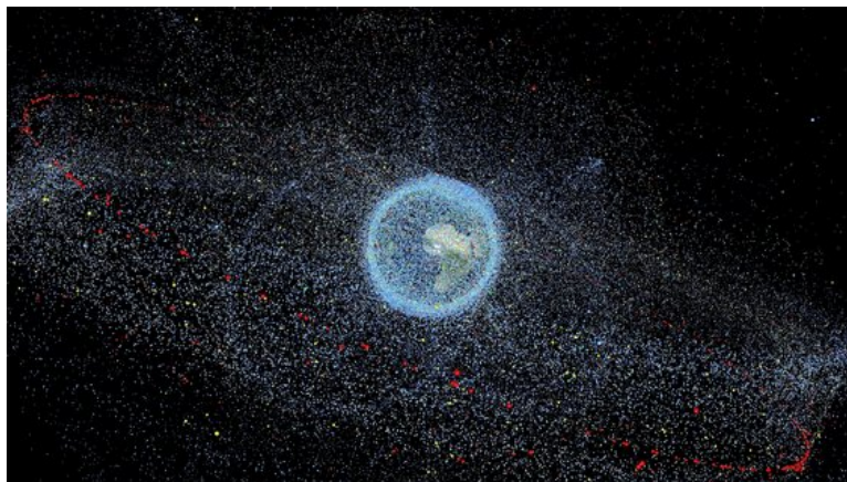
FIGURE 1 – Répartition des débris spatiaux autour de la Terre en 2017 - Visualisation des régimes orbitaux : (i) LEO pour les orbites basses formant une coque autour de la Terre, (ii) GEO pour l'anneau géostationnaire, et (iii) MEO pour les orbites intermédiaires (© European Space Agency (ESA)).
