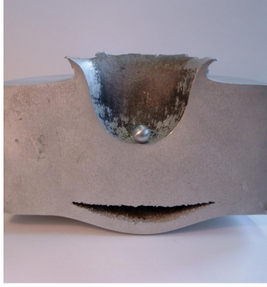
FIGURE 1.8 – Perforation d’une surface en aluminium par une bille d’un centimètre de diamètre lors de tests d’impacts à très haute vitesse, typiquement entre 10 et 15 km.s -1 (© ESA).
