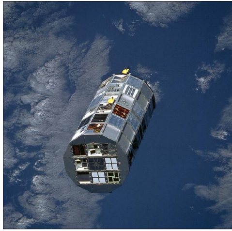
FIGURE 1.19 – Système spatial placé sur une orbite à 475 km d’altitude dans le cadre de la mission LDEF développée par la NASA (© NASA).
