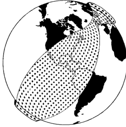
FIGURE 3.2 – Transition entre la phase B et la phase C au cours de laquelle le nuage de débris ne peut être décrit ni comme un tore, ni comme une bande. Illustration tirée de l'article rédigé par [10].
